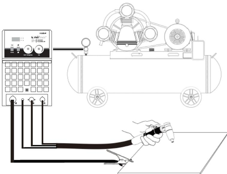
Рис. 2 Подключение аппарата SAGGIO PLASMA 85. Передняя панель
