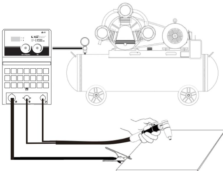
Рис. 1 Подключение аппарата SAGGIO PLASMA 65. Передняя панель
