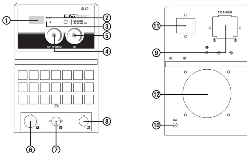
1. **Цифровой дисплей:** отображает значения тока резки;
