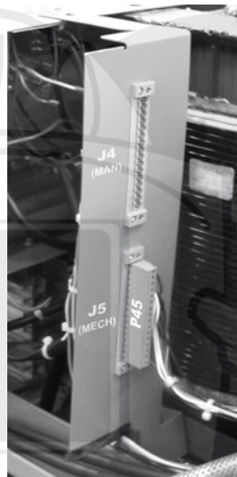
P45 передвигается к J5 (MECH) когда свободно стоящая распределительная коробка должна быть передвинута.
